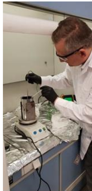
Dozowanie neutralizatora do próbki gorącego asfaltu.
